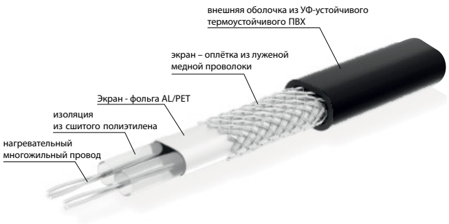
Конструкция нагревательного кабеля ELEKTRA VCDR
